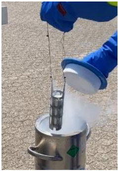
接続用ピンを液化窒素で冷却・収縮し、挿入・結合
