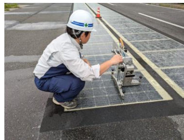
振り子式スキッドレジスタンステスト によるすべり抵抗測定
