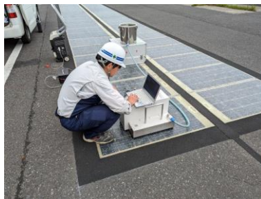
回転式すべり抵抗測定器 による動的摩擦係数の測定
