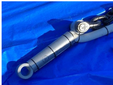
張力計による計測
