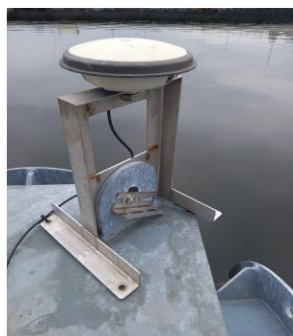
GNSSによる変位計測
