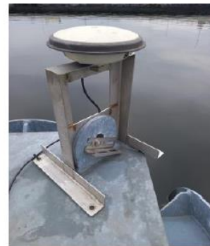
GNSSによる変位測定 (浮体)
