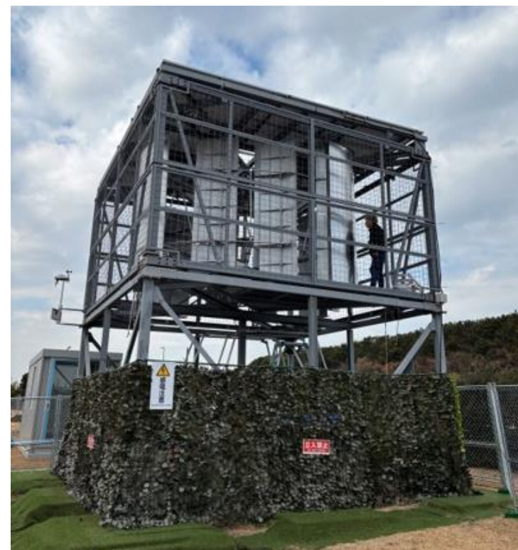
抗力・揚力併用型の改良型システム (仕様は次ページ参照)
