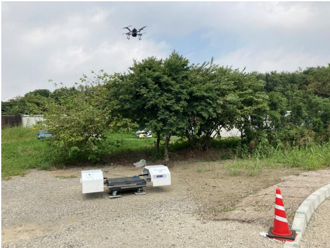
海の森で飛行中の充電ポート付きドローン
