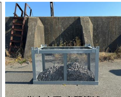
指定水面(半閉鎖域)でのスラグ設置
